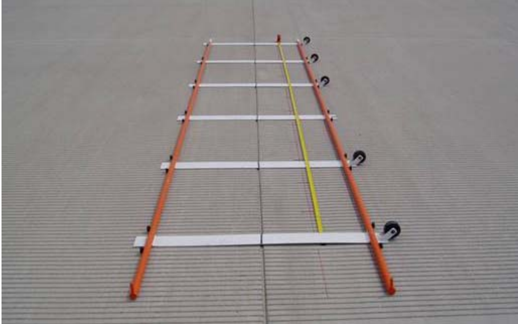
Figure 17. Identification of dowel location using MIT Scan-2.
